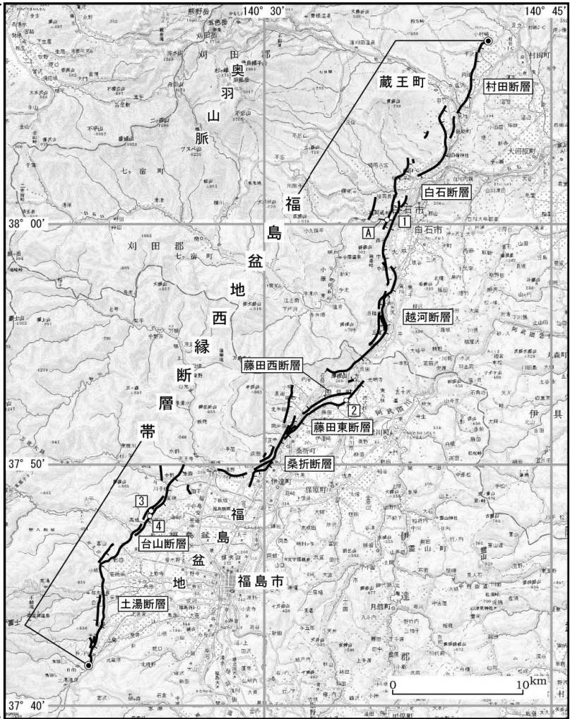
図 2 福島盆地西縁断層帯の位置と主な調査地点 1: 菅生田地点 2: 森山地点 3: 大笹生B地点 4: 大笹生A地点 A: 反射法弾性波探査測線 (文献7) ●: 断層帯の北端と南端 断層の位置は文献3に基づく。 基図は国土地理院発行数値地図200000「仙台」「福島」を使用。
