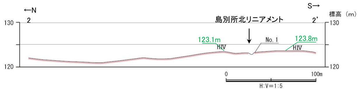
地形断面図(航空レーザ計測データにより作成)
