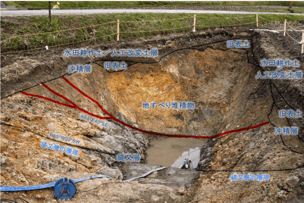
地山の縄文層と地すべり堆積物とを境する断層破碎帯(川辺ほか, 2007) 「断層」とされる道路の割れ目の写真(川辺ほか, 2007)
