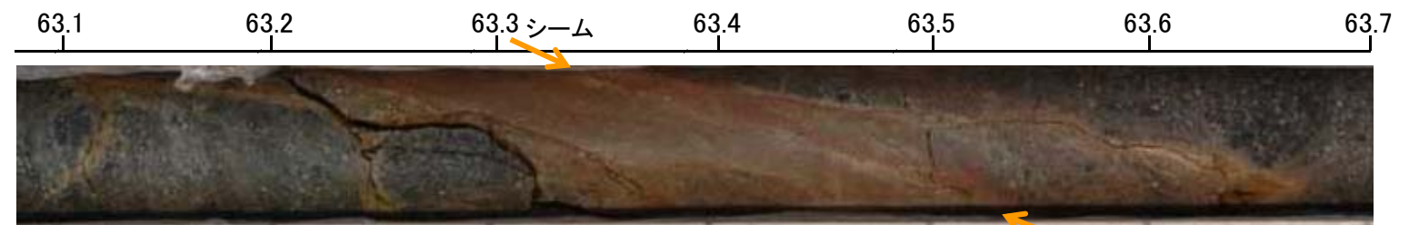
コア写真(シーム部付近拡大)
