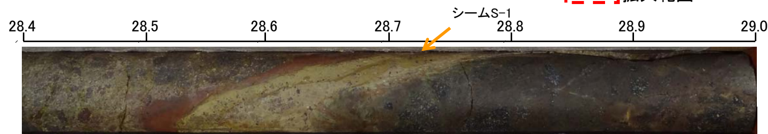
シームS-1 コア写真(シーム部付近拡大)
