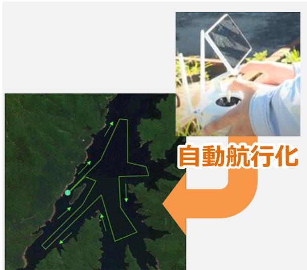
ダム湖面の巡視点検をドローンによる自動航行とすることで、船舶を用いた目視点検を合理化。船舶および船舶用クレーン設備の廃止が可能であり、設備維持費用を削減。
