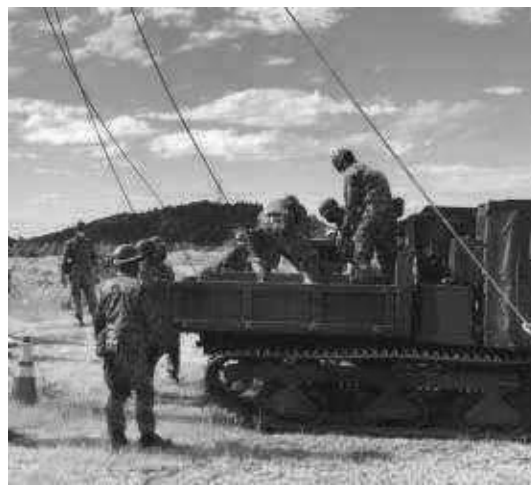
不整地運搬車による変圧器運搬
