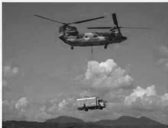
航空自衛隊の大型輸送ヘリコプターによる高圧発電機車の懸吊訓練
