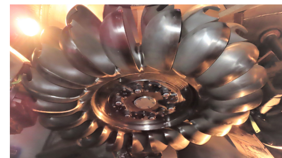
栃尾発電所ランナ（水車羽根車）
