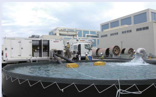
可搬型代替海水ポンプの操作訓練 原子炉補機を冷却する海水系の取水機能が喪失した場合に用いる可搬型代替海水ポンプ車により循環運転訓練
