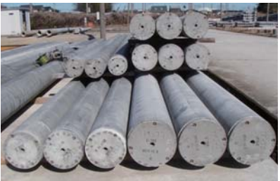
石炭灰の有効利用コンクリート柱
