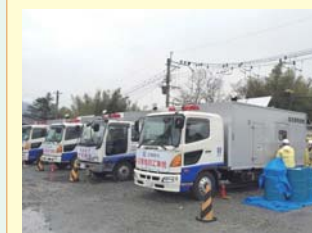
高圧発電機車4台による病院等への送電
