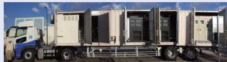
可搬型窒素供給装置の設置
