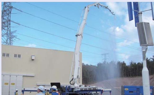
高所注水車の操作訓練 常設の配管による使用済燃料貯蔵プールへの注水やスプレイができない場合に用いる高所注水車からの放水訓練
