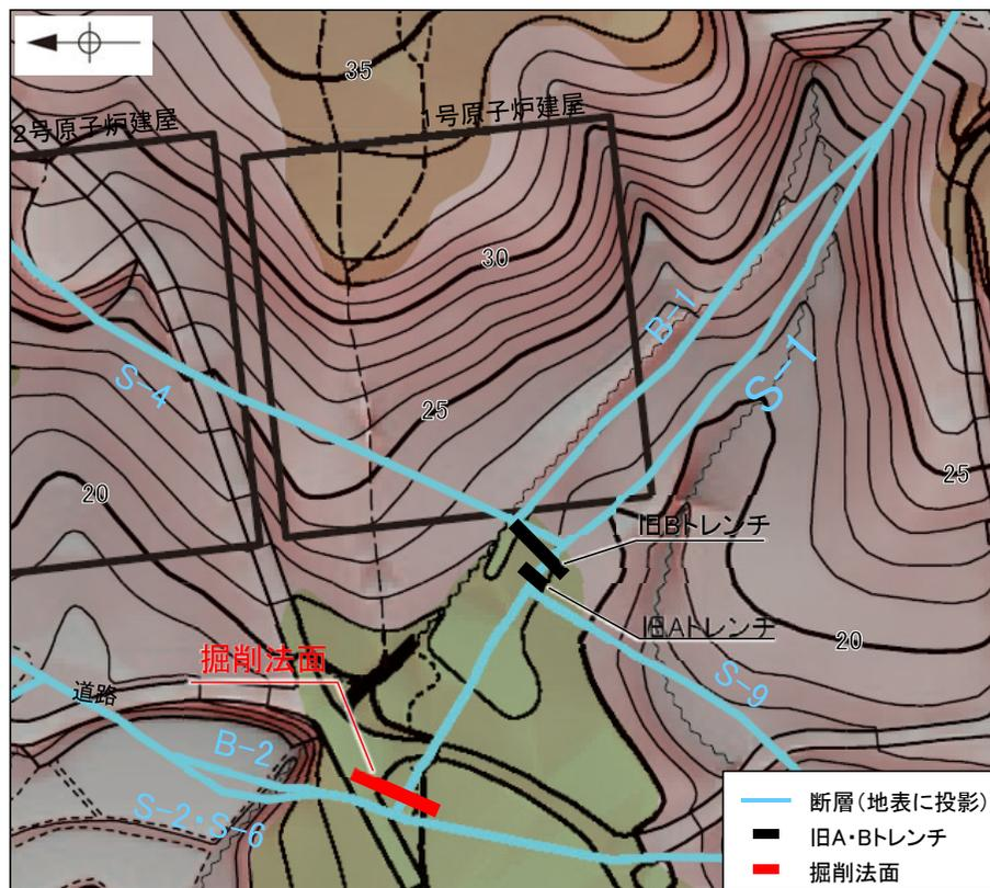
この図は、1985年の空中写真(北陸電力撮影、縮尺8,000分の1)、1961年の空中写真(北陸電力撮影、縮尺15,000分の1)及び水準測量結果をもとに作成した立体地図(等高線は1m間隔)を基図として、空中写真判読及び既存ボーリングの地質データ等に基づいた段丘面分布等を示したものである。
