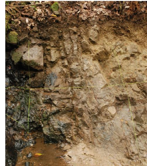
写真② 安山岩(均質)に発達する板状割れ目
