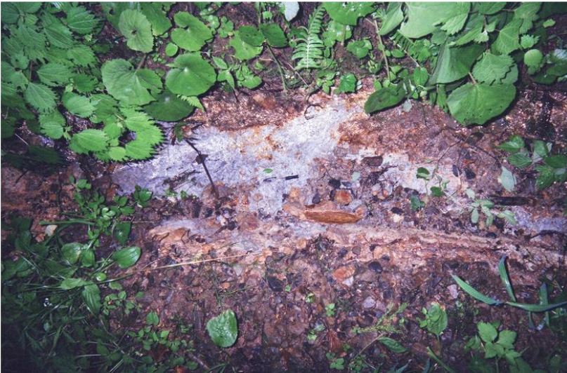
Loc.2 安山岩の礫を含む粘土 (2007年撮影) 丸みを帯びた礫や砂質分を多く含む土砂状となっており、岩組織を残していない。
