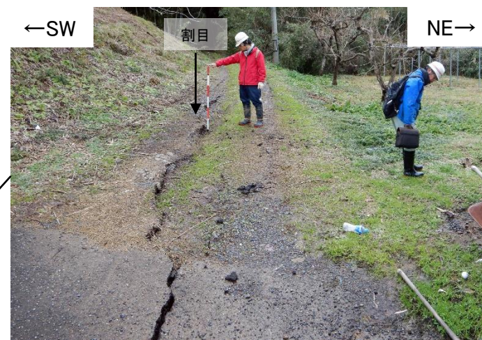
写真 ⑧地点(酒見西方地点)(2024年1月12日撮影) 路面に分布する割目。北東側(平野側)が沈下している。
