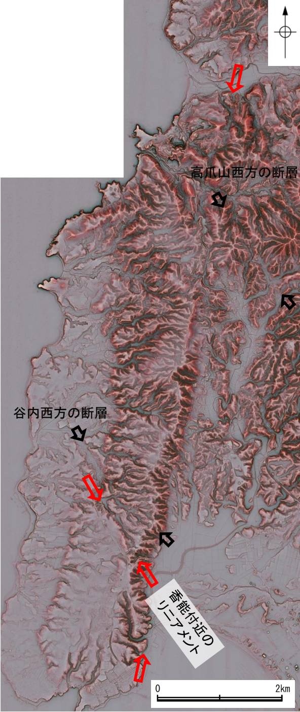
赤色立体地図 (航空レーザ計測データにより作成)
