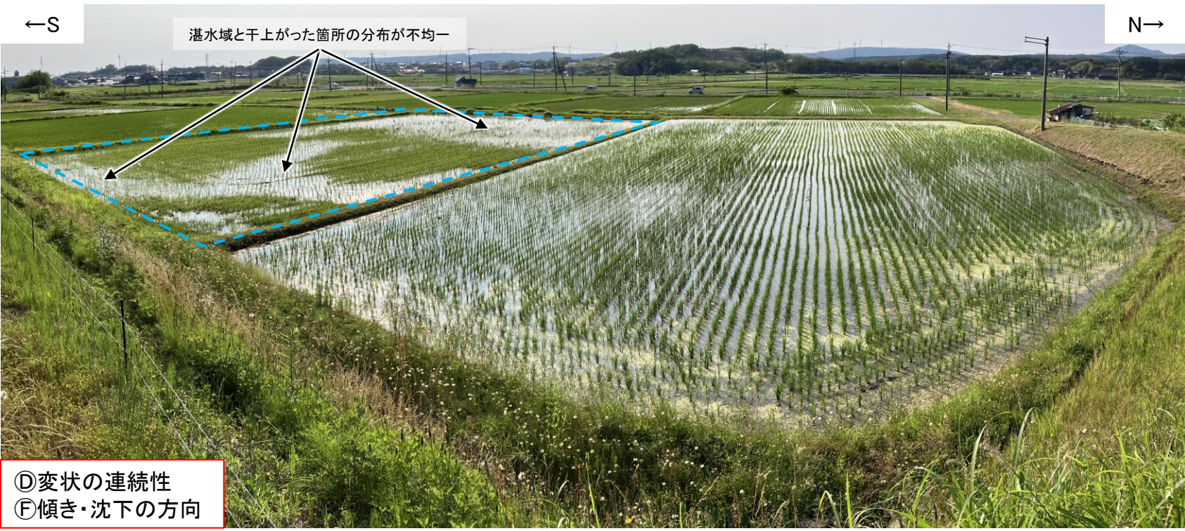
写真53(2024年6月11日撮影) 西方を望む。写真左側(西側)の田畑では、沈下を示す湛水域と干上がった箇所の分布が不均一である。それ以外の変状は認められない。
