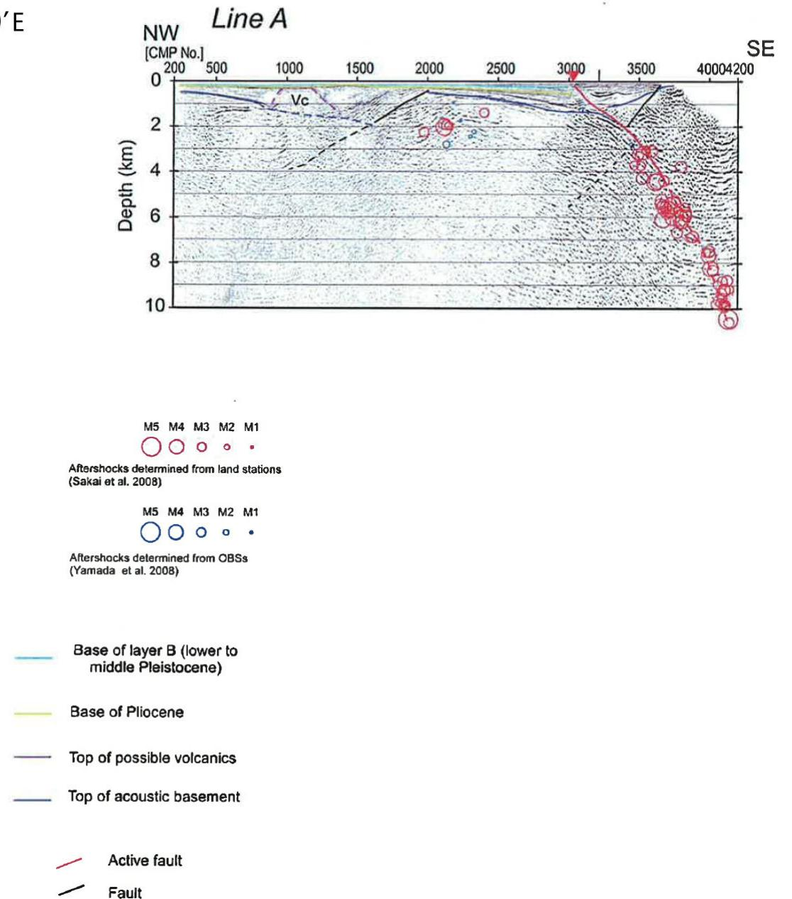
反射法地震探査及び余震分布に基づく断層面の形状
