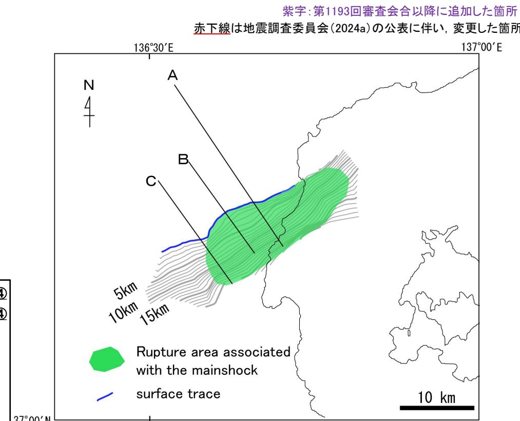
反射法地震探査及び余震分布に基づく断層面の形状
