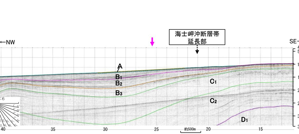
・K18測線, No.104測線, N-117測線は、明瞭な非対称性を示さない緩やかな構造であり、海士岬沖断層帯に対応する構造ではないと判断した。
