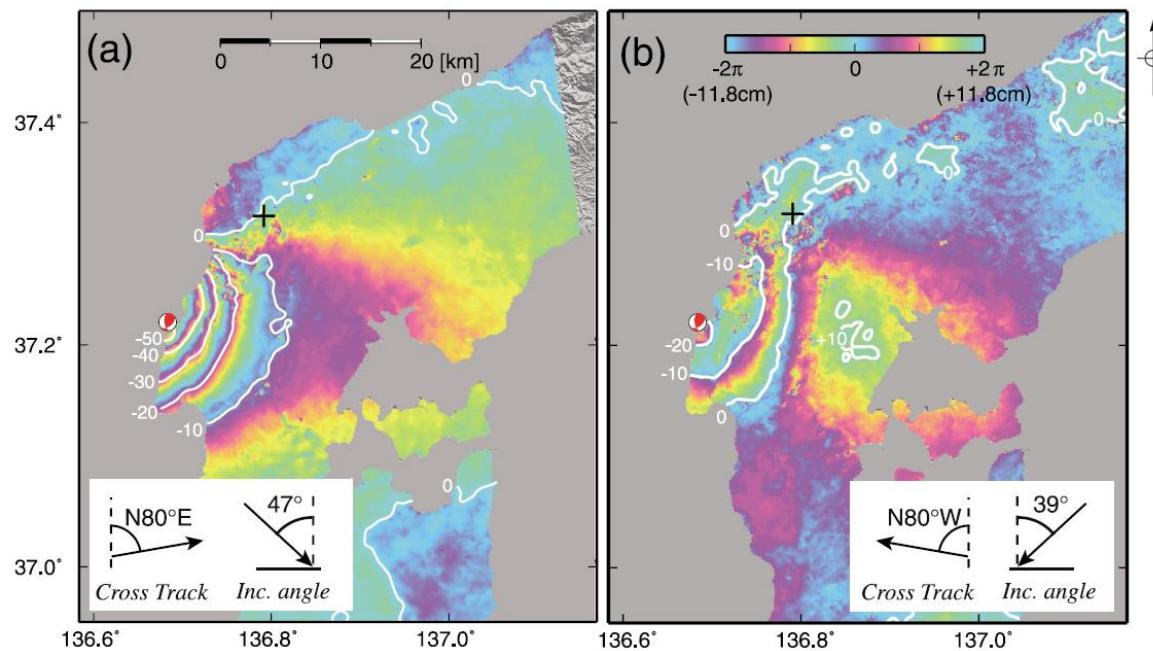
・ Fukushima et al.(2008)は、左図のSAR干渉画像が、地表断層の動きに関連するような不連続性を示していないことから、断層の破壊が地表に到達していないとしている。
