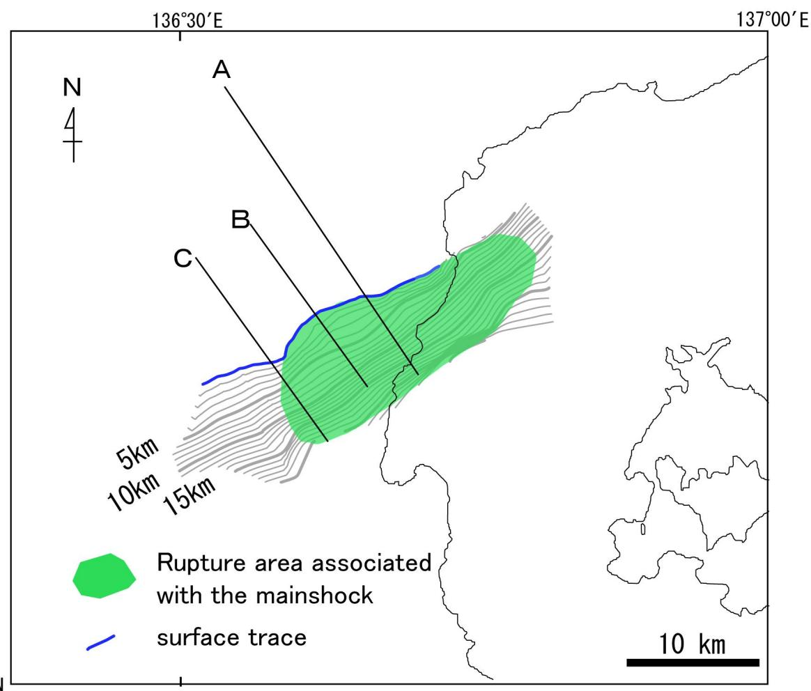
反射法地震探査及び余震分布に基づく断層面の形状
