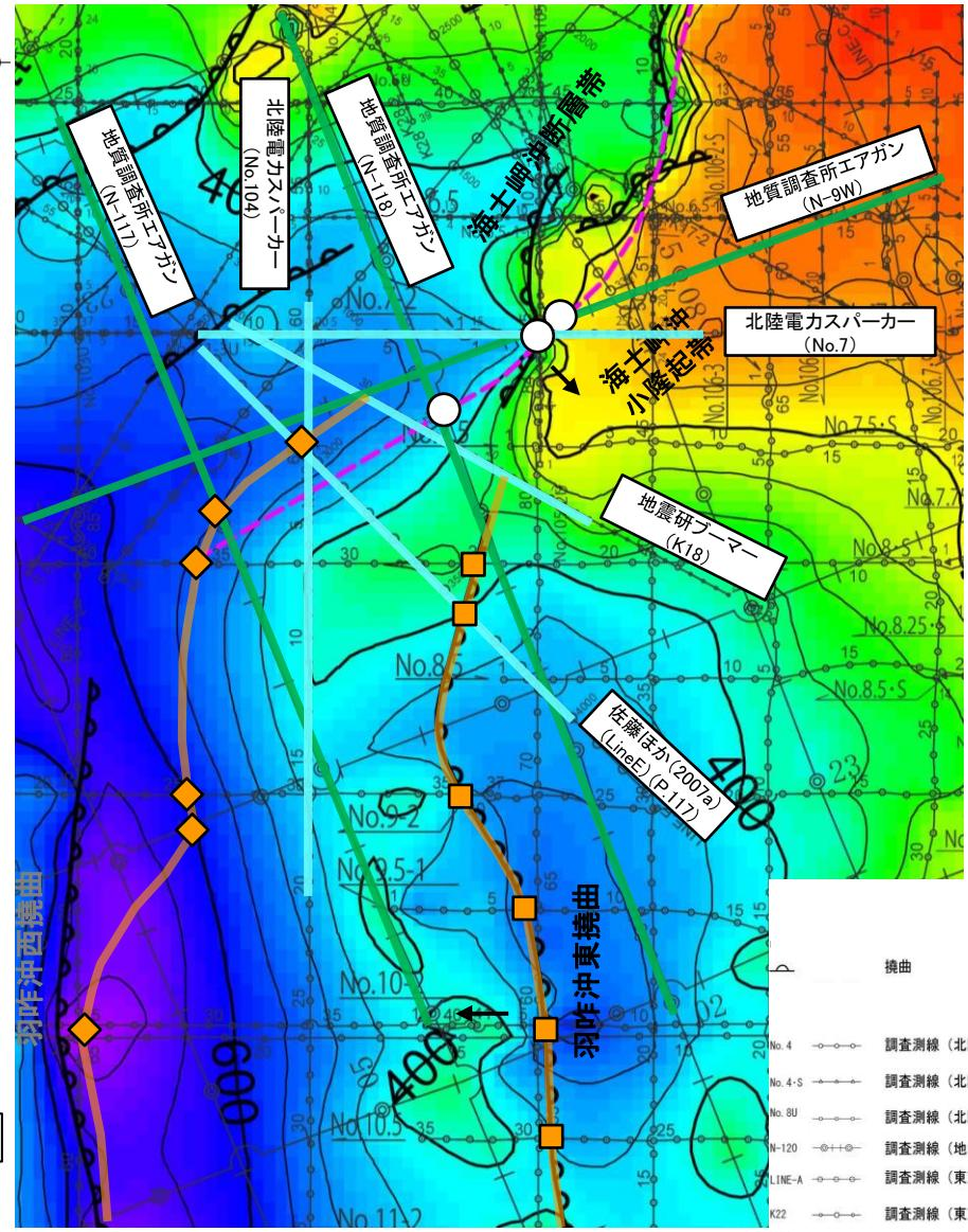
※東翼が急傾斜で西翼が緩傾斜の非対称褶曲構造で特徴づけられる(次々頁: No.8測線, No.9測線, N-118測線等)。羽咋沖東撓曲の評価は2.4.3項
