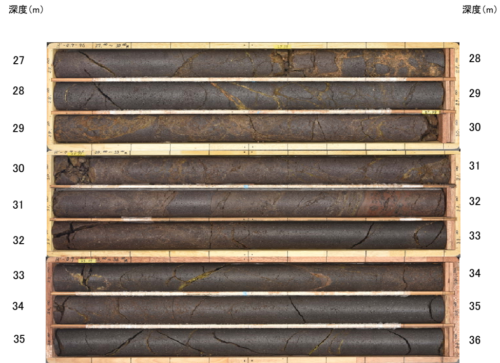
H' -0.9-45孔(掘進長40.00m, 傾斜45°)
