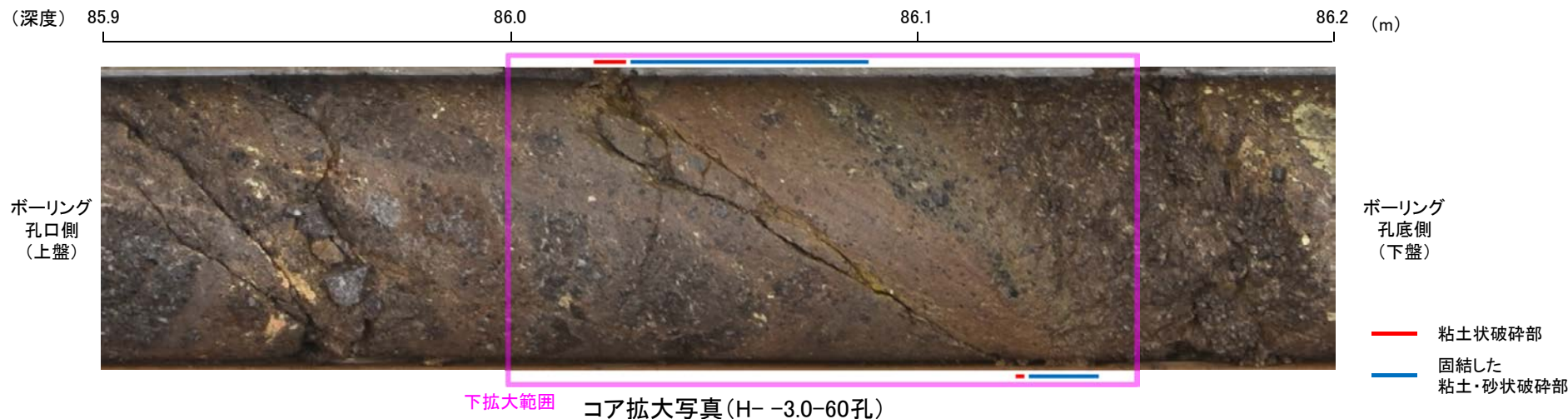
固結した破碎部のせん断面(=主せん断面)
