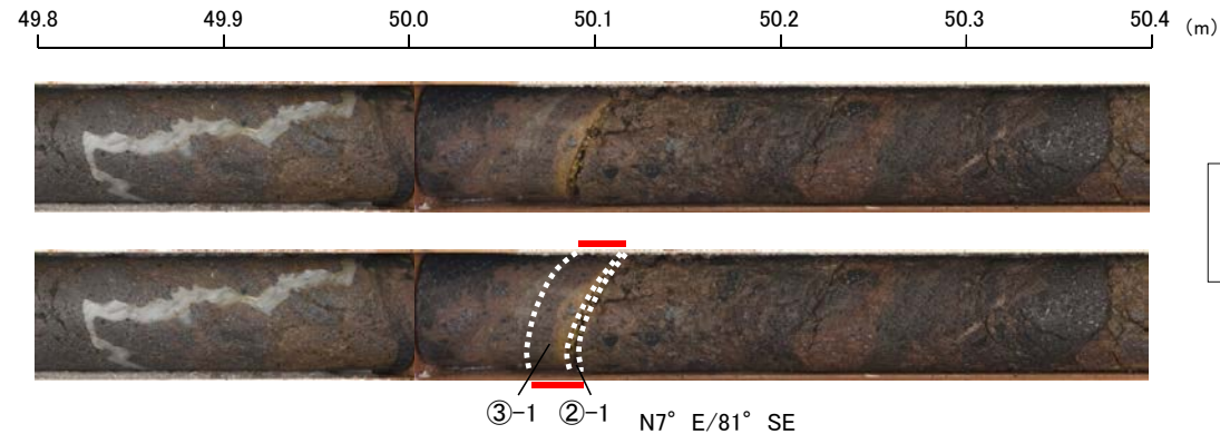
コア写真(G-1.9-20孔 深度50.10m) 下は破碎部加筆
