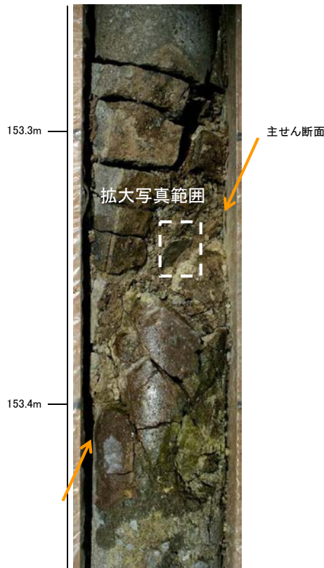
コア写真(S-1付近)
