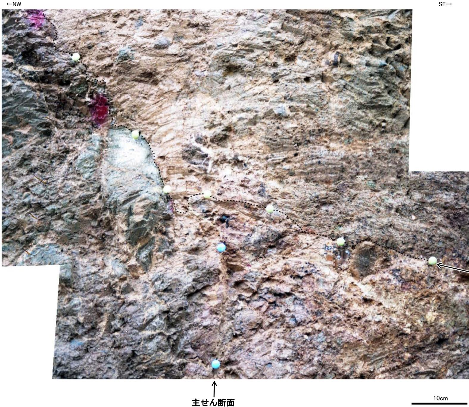
・堆積構造が確認できるトレンチ壁面の詳細な写真の観察によれば、主せん断面の直上において、岩盤の上面に段差はなく、その直上を覆う砂礫層（少なくとも約12～13万年前以前の堆積物）に断層変位を示唆するようなせん断面や地層の擾乱は認められない。
