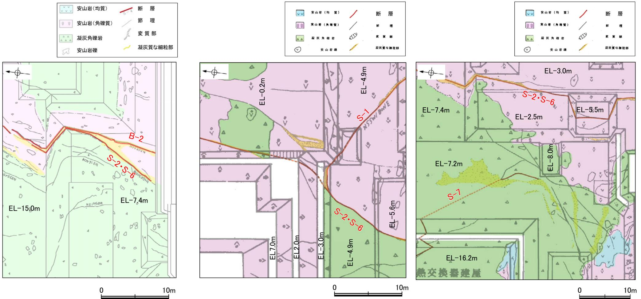
(図6)S-2・S-6とB-2の会合部の基礎掘削面スケッチ
