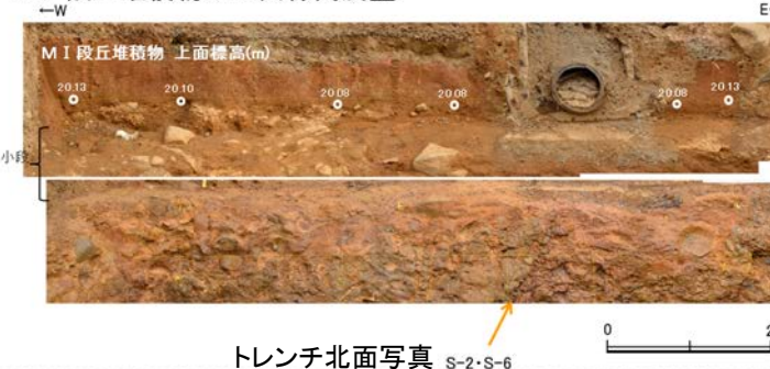
M I 段丘堆積物の上面標高測量
