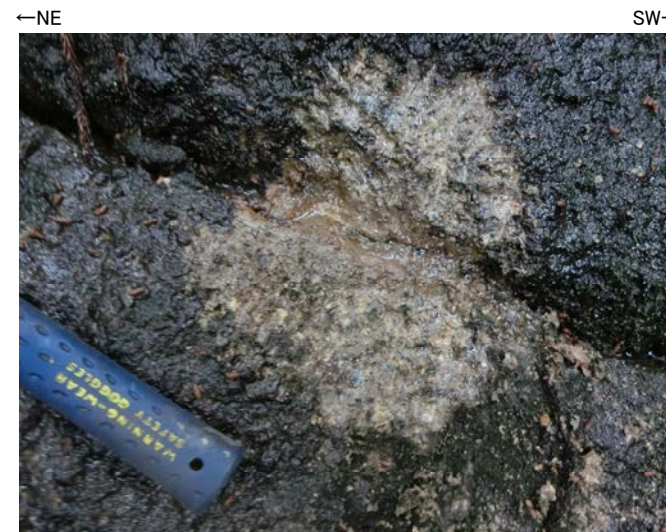
写真⑤-3 走向N75° Eの節理
