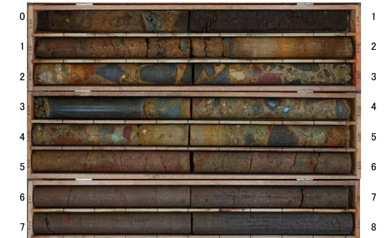
US-N09(孔口標高45.01m, 掘進長8m, 鉛直)
