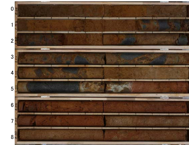
US-N05(孔口標高43.19m, 掘進長9m, 鉛直)
