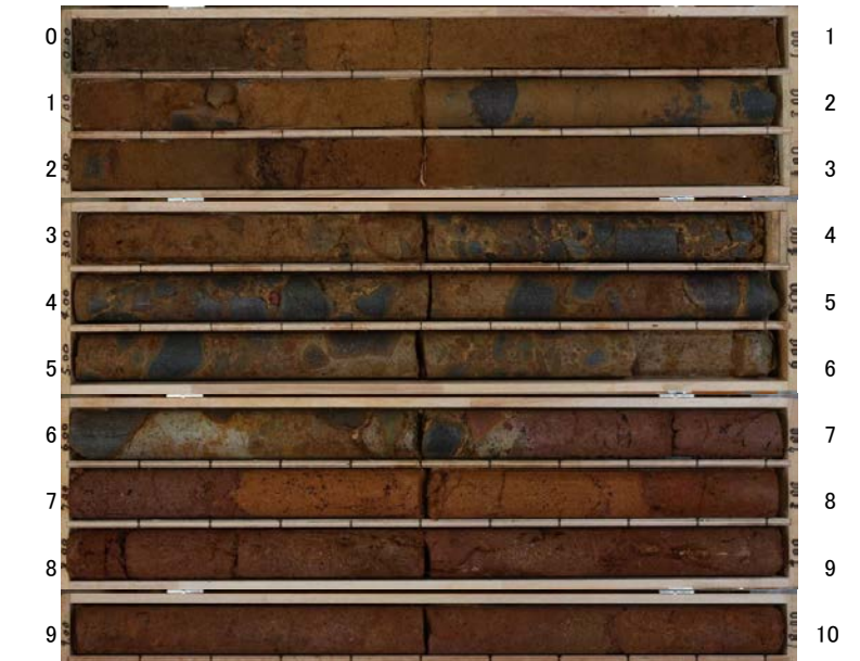
US-N03(孔口標高46.16m, 掘進長10m, 鉛直)
