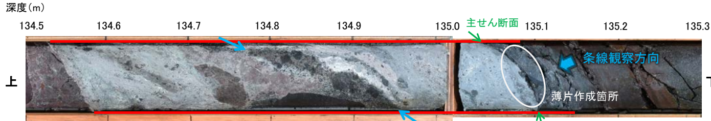
コア写真(TJ-1孔, 断層付近拡大)
