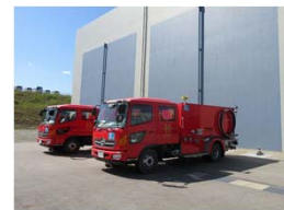
可搬型低圧注水ポンプの配備
