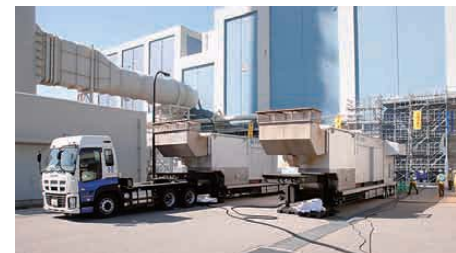
大容量電源車 [4,000kVA] (1号機用：1台, 2号機用：1台)
