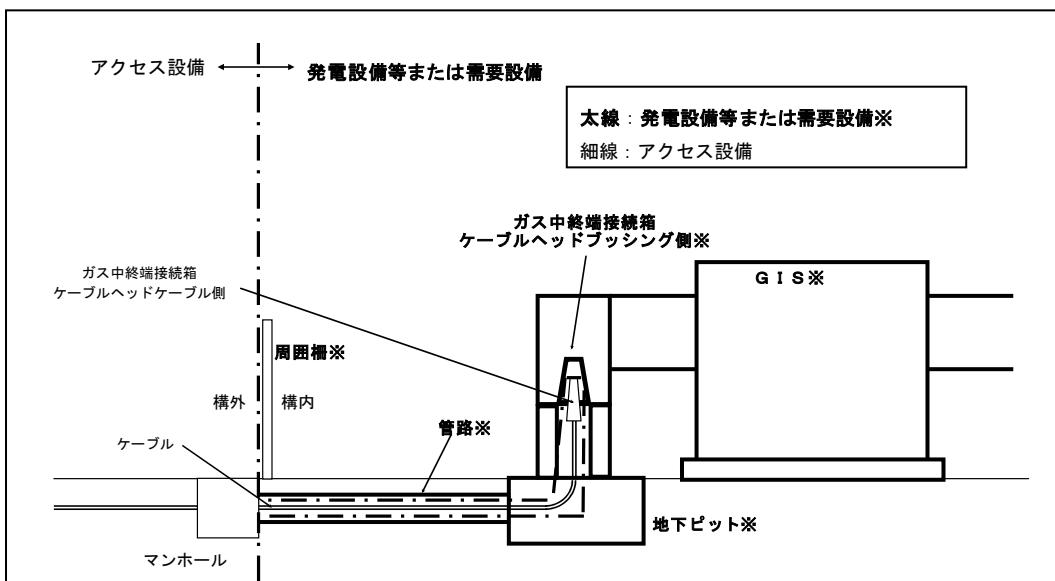
図 2-10 地中引出線および地中引込線における分界点の例 (G I Sの場合)
