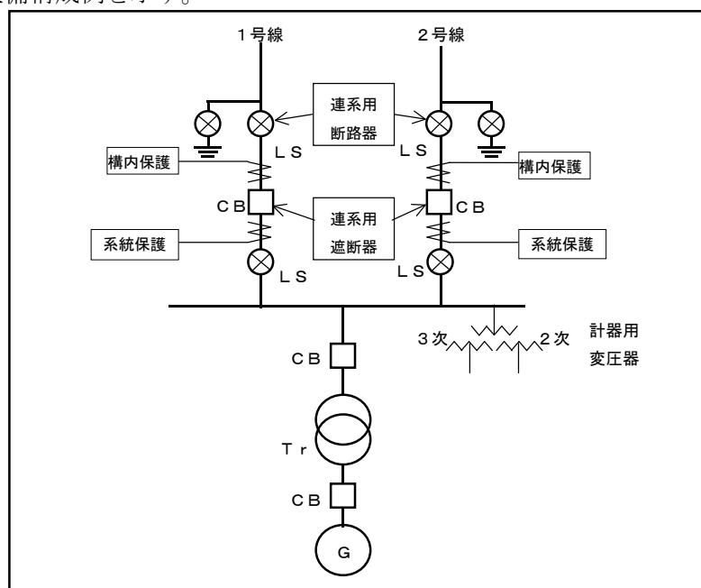
図 3-1 発電者の連系設備構成の例
