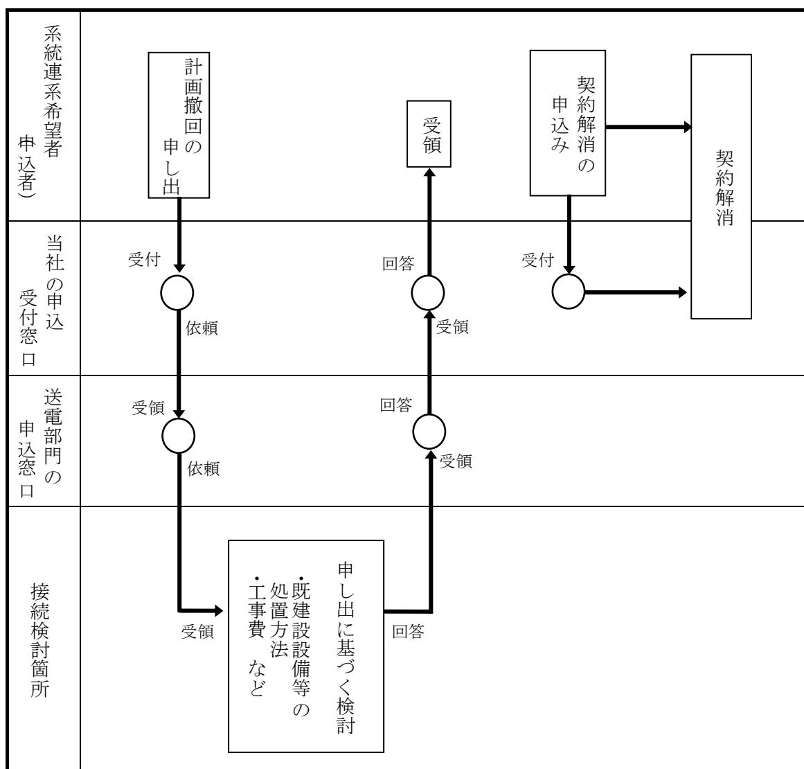
図 2-13 系統連系申込者が計画撤回を申し出した場合の業務フロー
