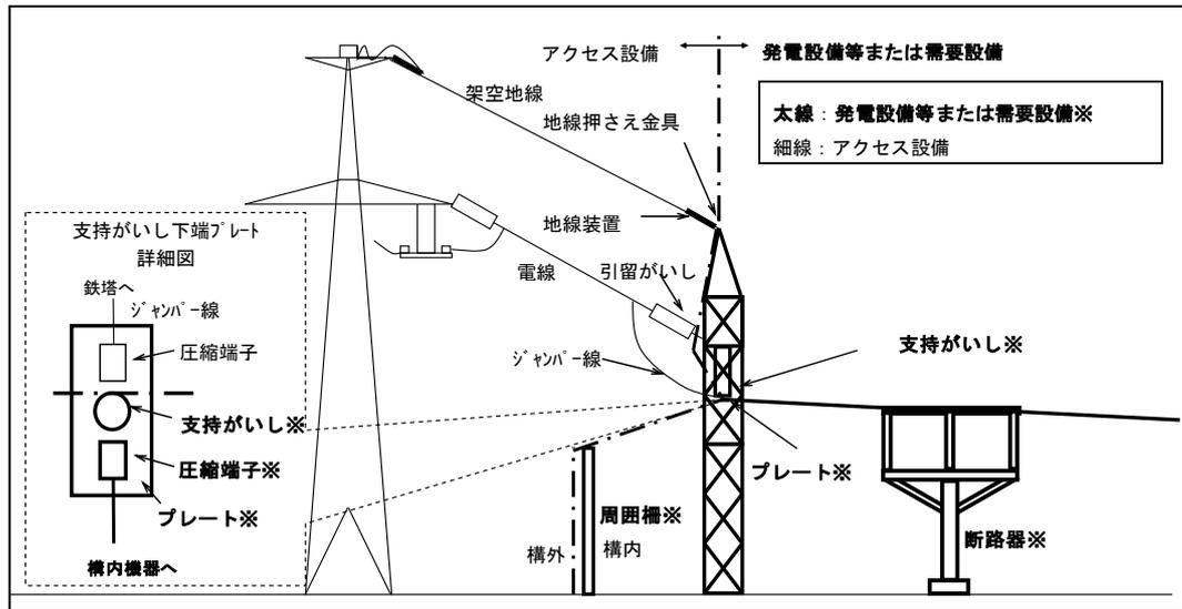
図 2-8 架空引出線および架空引込線における分界点の例
