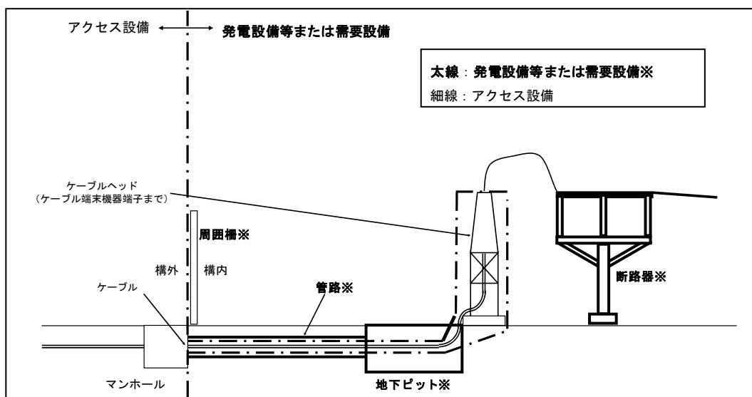
図 2-9 地中引出線および地中引込線における分界点の例 (ケーブルヘッドの場合)
