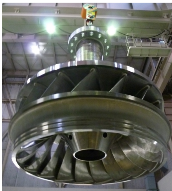
有峰第二発電所 水車羽根車（ランナ）
