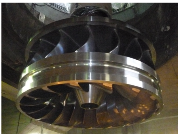
東町発電所 2号水車羽根車（ランナ）
