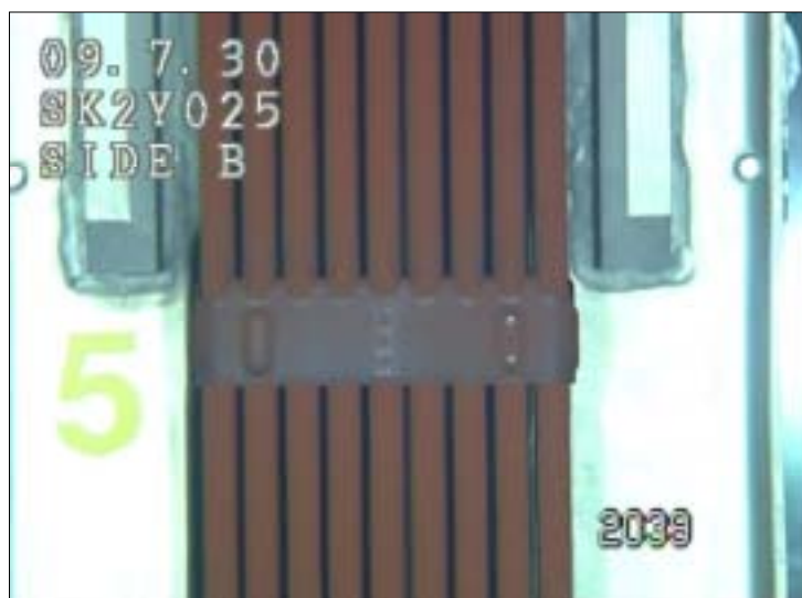
水中テレビカメラの映像(第5スペーサ部をB面から観察した例)
