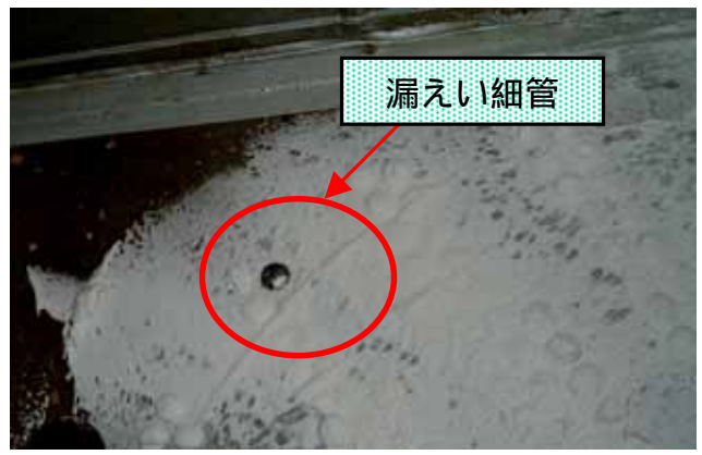
漏えい検査状況
