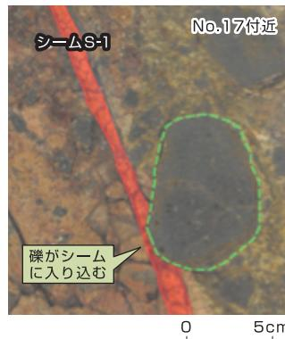
・岩盤調査坑において、安山岩礫がシームS-1を分断するように分布していることなどから、シームS-1は、安山岩礫を破断させるなどの動きがあったとは考えられません。
