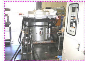
アスベストを無害化する150kW誘導加熱炉
