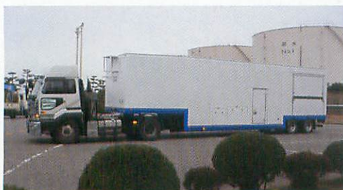
オンサイト式アスベスト無害化処理システムを搭載したトレーラー
