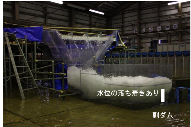
第15図 新設洪水吐より 230m³/s 放流 (副ダム設置)
