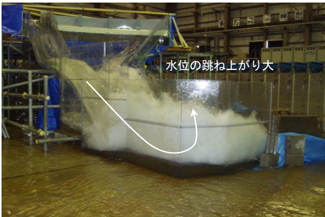
第12図 【改修前】現洪水吐ゲートより 220m³/s 放流
