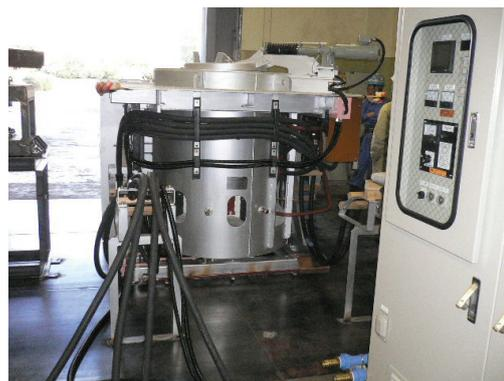
第2図 150kW 誘導加熱装置の外観写真
