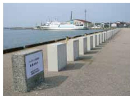
第 3 図 試験体暴露状況
