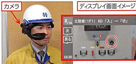
図2 ウェアラブルカメラ・モニターによる遠隔支援の検証例
