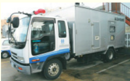
電源車【電源車の仕様】300kVA×5台
