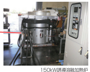
150kW誘導溶融加熱炉
