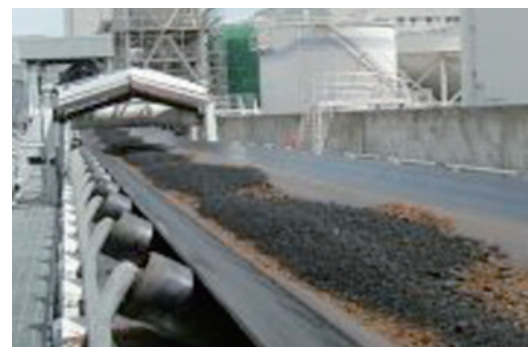
木質バイオマス燃料搬送状況(敦賀火力発電所)
