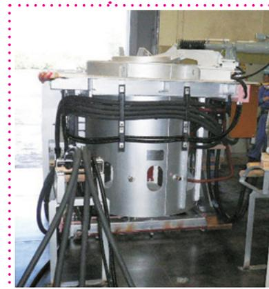
150kW 誘導加熱炉
