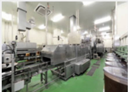
導入機器 | ・アームラック式IH炊飯設備
