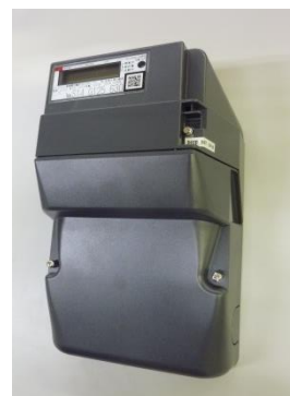
スマートメーター
